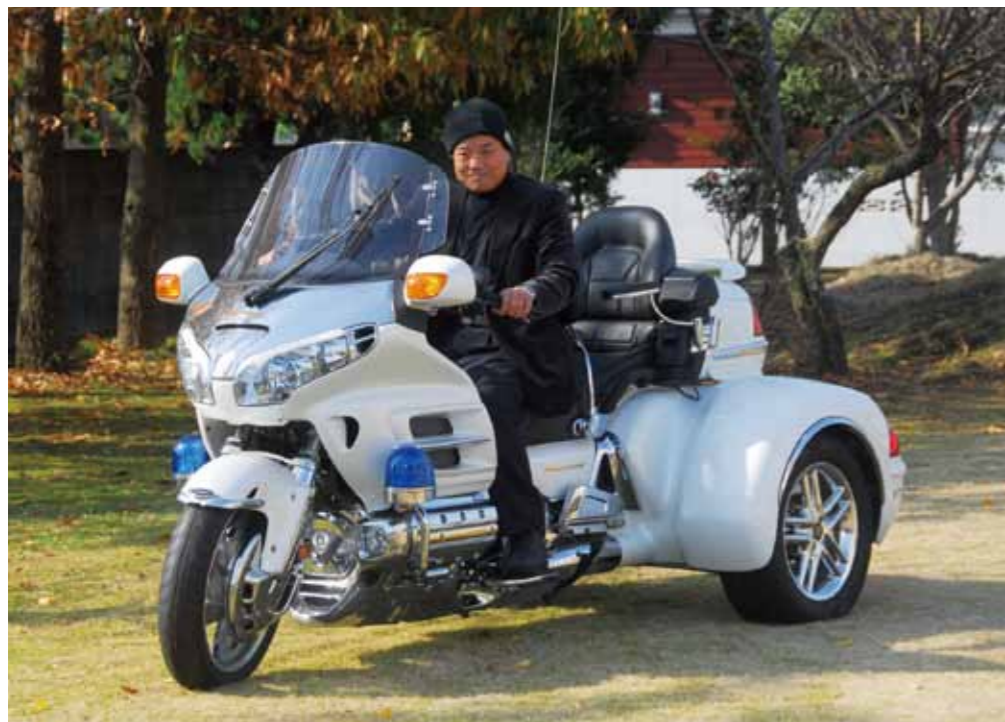
1:トライクのフロントマスクには、クロームフェアリンググリルやヘッドライトに変えられている。2:右ハンドルスイッチはクルーズコントロール系、オーディオボリューム、ウィンカー、ホーン等。4:千葉県松戸市にあるショップだ。5:銀色に輝くパーツがハンドルアップキット。ゴツいアストロバスタードスイッチ、ボタン操作で調整可能なリアショックフルコントロールだ。7:トライクの後輪2本は正に車同様で、1本が205/60R15サイズである。
